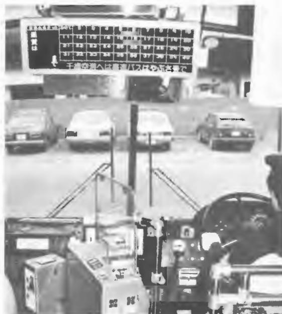
ワンマン路線バスに装着されたデジタル運賃表示器、自動両替器付運賃箱、整理券器
